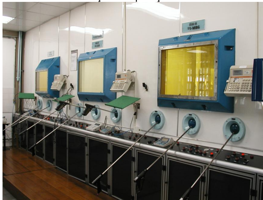
FIGURA 3 - Vista frontal de Célula de processamento de radiofármacos do IPEN-CNEN/SP
